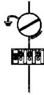
Отворете заземителя, за да позволите достъп до проводниците
